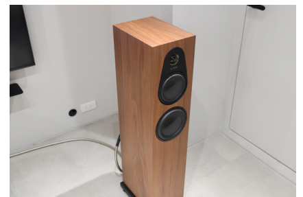
● 喇叭使用的是三音路落地喇叭150，但內中已經改為數位分音模式，在Selekt DSM分音完之後再分成6路個別驅動喇叭單體。
