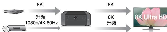
本產品配備, 8k 視頻升頻功能, 可透過 HDMI 以 1080p/4K60p, 升頻 8K (7680 × 4320 像素) 分辨率輸出視頻。此功能使設備可以使用單一 HDMI 電纜連接到電視, 並為任何視頻源生成高清圖像。
