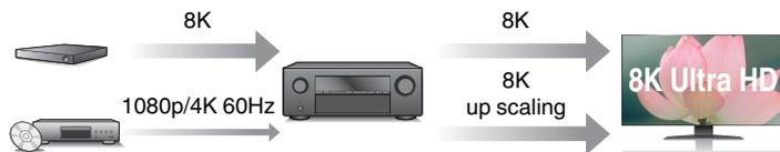
本產品配備了 4K 視頻升級功能，允許將 1080p 或 4K 視頻以 8K 解析度透過 HDMI 輸出。此功能使設備能夠使用單個 HDMI 電纜連接到電視，並為任何視頻訊源還原高清圖像。
