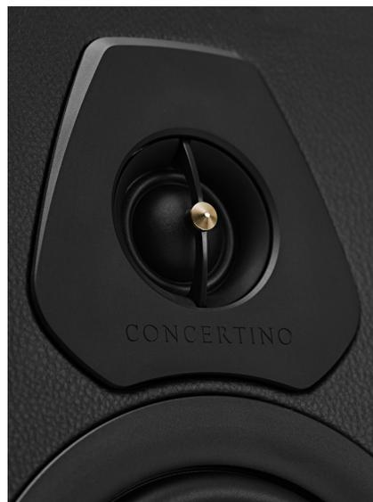
● 所謂的DAD Arrow Point高音單體一直都是原廠厲害的設計之一，振膜為一只1.1吋絲質材料。原廠在振膜前方配置了彷彿弓箭一般的弧形裝置，並利用阻尼物與振膜中央微微觸碰，可降低失真產生。
