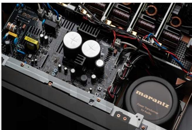
←AMP 20的電源電路位於機內前方，右邊的環形變壓器是輸入緩衝放大電路的電源，左方的交換式電源板則是負責供電給D類功放模組。
