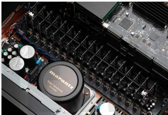
↑ AV 20以環形變壓器作為聲頻電路的電源，兩側的電源板配備大容量濾波電容。
