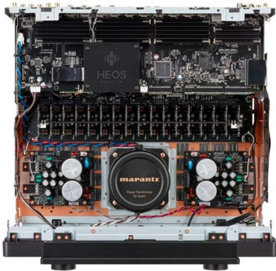
↑ AV 20的機內電路分為三區：後段主要包含數位電路主板與數類轉換電路，中段是13.4（17）聲道前級放大電路，前段是聲頻電路的專屬電源。
