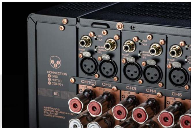
↑ 輸入端子之間有兩個切換開關，可選單端或平衡輸入，採取Bi-Amp、一般或橋接輸出。
