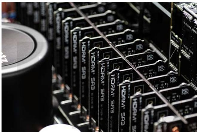
↑ AV 20在數類轉換與音控之後，每聲道各使用一塊HDAM-SA3電路板，以所有聲道獨立的單聲道化製作獲得更高的分離度。
