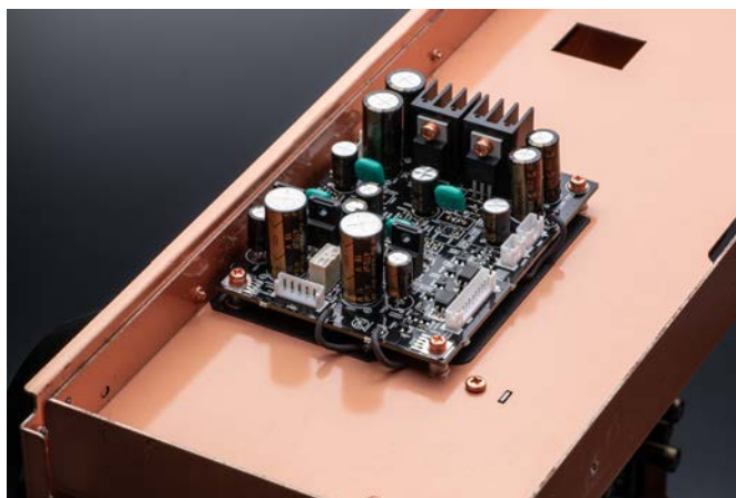
↑ 耳擴也是用電晶體與被動元件製作的緩衝放大電路，由Marantz自家研製，不用OP Amp或現成的耳擴晶片。
