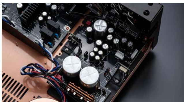
↑ 聲頻電路的電源使用高速SiC蕭特基整流二極體與訂製的電解電容。
