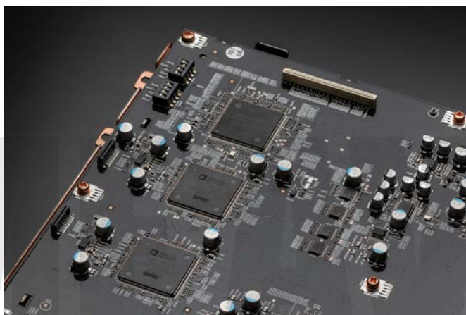
↑ LINK 10n的MMM-Stream電路以DSP晶片做數位音訊處理，把輸入的PCM音訊擴張為32 bit再做256 fs的數位濾波與Delta-Sigma調變。
