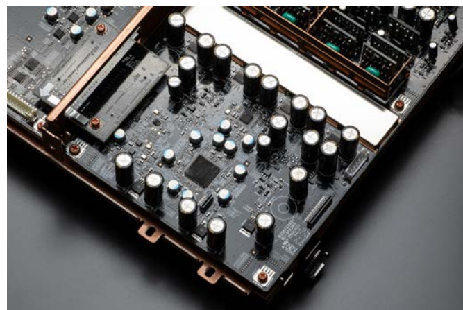
↑MMM-Conversion是用Altera MAX V CPLD晶片控制D型正反器（Marantz把它稱為data buffer）與電阻陣列組成的DSD數類轉換電路，本圖看不到全平衡架構的正反器與電阻陣列，因為它們就位於條狀銀白色金屬的下方，把它們包覆好就是要避免高速切換的噪訊外洩，確保聲頻信號的純淨度。
