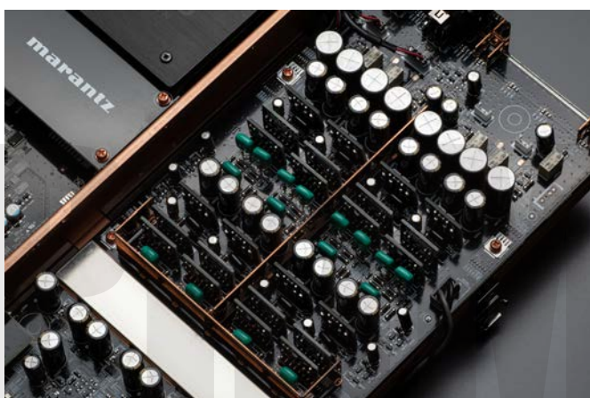
↑MMM-Conversion後段以多個HDAM與HDAM-SA3模組組成全平衡低通與輸出緩衝放大電路，前緣與正反器電阻陣列交接處有屏蔽降低雜訊，左右聲道之間也有屏蔽。
