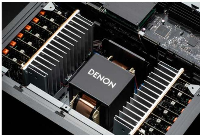
↑ 請注意電源變壓器後面的地方，這是用矽鋼片、鋼板與塑膠片組成，目的是擋住變壓器的電磁波（作為屏蔽），減少對前級聲頻電路的負面影響。
