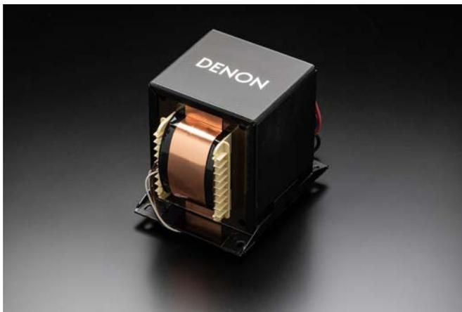
↑ AVR-A10H的重量級變壓器是聲頻（類比）電路的專屬電源（數位電路另以SMPS電路板供電），這個電源變壓器有8.1公斤重，以OFC線材繞製而成。
