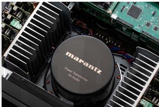
↑ CINEMA 30用環形變壓器、外面還有防磁罩，漏磁已經很低，原廠還故意把左右對稱配置功放電路的散熱片朝向電源變壓器，相當於再加上一重屏蔽。
