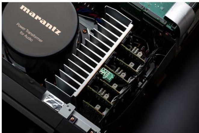
↑本機的后級電路是單聲道化的製作，每個聲道用一塊獨立的印刷電路板。
