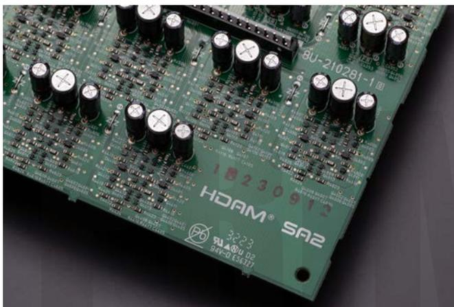
↑ 更靠近看本機的前級放大電路板，各聲道的HDAM SA2放大電路都是以獨立元件（電阻、電容、電晶體）組成，跟絕大多數環繞擴大機前級用OP Amp晶片放大有很大的差別。
