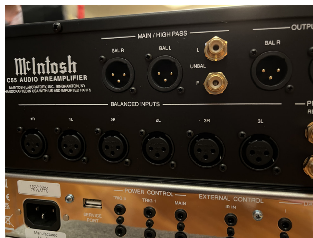
● 這是C55的Power Control與External Control端子。
