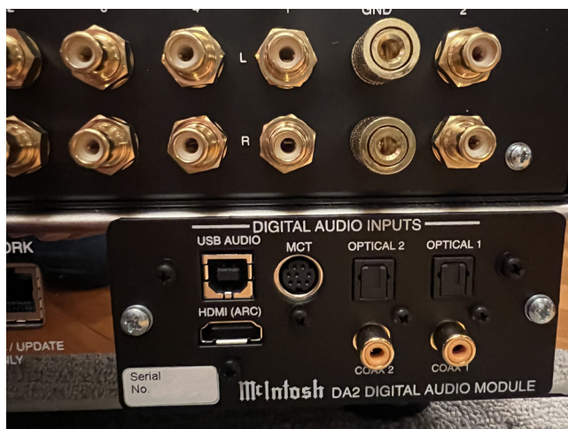
● 這塊模組稱為DA2 Digital Audio Module，各種數位端子齊備。
