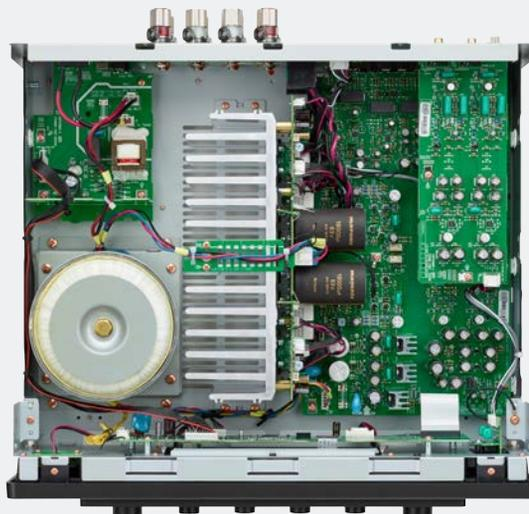
且為了讓音頻電路擁有更穩定的電流供應，Model 50搭載的更大的環型變壓器（圖4），搭配兩顆Marantz特製的18,000 $\mu$ F濾波電容（圖5），且為了提高瞬時電流供給能力，徹地落實了功放電路的最短供電路徑，直接將功放電源電路和輸出級整合再一起，以往由主電源連接至輸出級的導體也從過去的0.035mm銅箔更換為1.0mm的銅棒（圖6），大幅降低了傳輸阻抗，換來的是更好的音樂動態效果。
