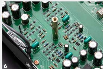
包覆雙重屏蔽隔離，再以矽鋼環繞在周圍，搭配兩顆Marantz特製的18,000 $\mu$ F濾波電容，提供源源不絕的電流供應。這樣還沒完，原廠為了提高瞬時電流供給能力，徹地落實了功放電路的最短供電路徑，直接將功放電源電路和輸出級整合再一起，以往由主電源連接至輸出級
