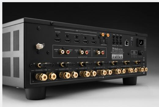
與後級輸入分離，舉例來說，我只要把原本LB/RB（後環繞聲道）的Jumper拔掉，把原本空接的Height L1/R1前級輸出用兩條信號線連接剛拔下Jumper的兩個IN端子（後級輸入），這樣就把MHT300從7.2聲道改成5.2.2聲道了。
