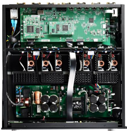
↑ McIntosh美國製造的品質相當精良，環繞擴大機的電路複雜性遠高於二聲道器材，MHT300還能做得如此工整潔淨，的確不簡單。機內後方由上至下依序是數位主板、前級與後級電路，前方三分之一則為電源電路。
