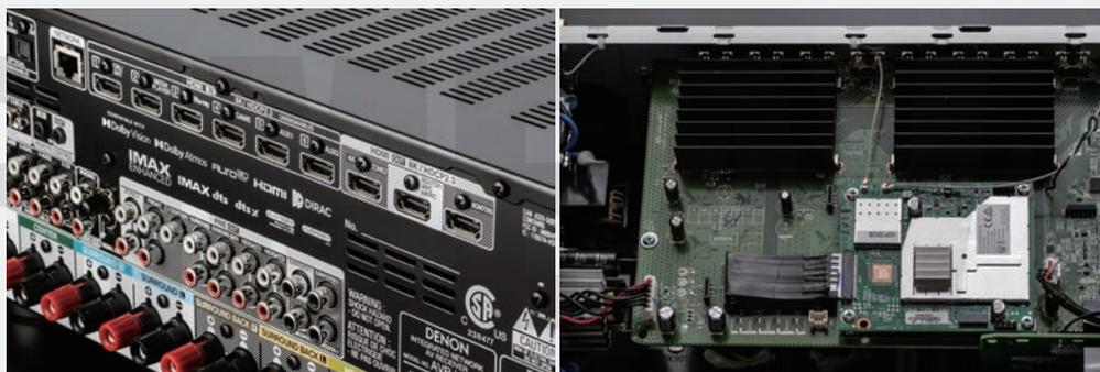
有與AVR-A1H類似之處，正常來說，只要不是旗艦環繞擴大機都會使用8聲道DAC晶片做數類轉換，以AVR-X3800H的前級總處理聲道數11.4聲道用兩枚8聲道DAC就能搞定，但它卻是採取「二聲道化」的DAC結構，總共使用8枚32bit二聲道DAC晶片TI PCM5102A（動態範圍112dB），搭配具有低噪音、低失真與寬頻特性的雙OP Amp JRC NJM8080加上被動元件做成的緩衝放大電路，本機的數類轉換電路是一塊垂直組裝的獨立電路板，它也像是一塊「連接板」、上下兩方分
