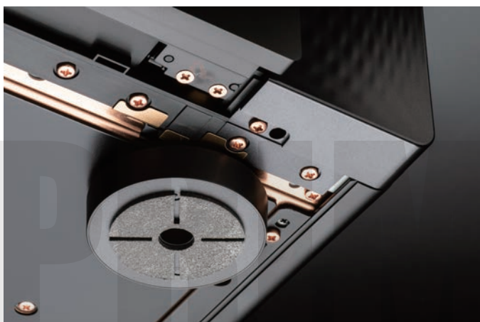
↑ 底部以三層構造加強剛性做抑振，加上高密度抑振腳。從這張照片還能看到中間有一層是黃銅色，這是以鍍銅鋼板製成的主箱體，此材料原本是作為軍事用途，優點是造價不高、阻擋高頻與低頻電磁波的效果卻相當好。
