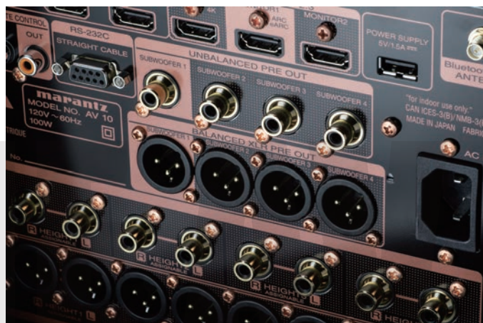
↑ AV 10可以接四支超低音喇叭還能個別設定調校，超低音輸出端子單端與平衡都有，如果您使用的超低音喇叭有平衡輸入，就應該以平衡為優先，這樣就算距離遠要接長線也不會感應哼聲。
