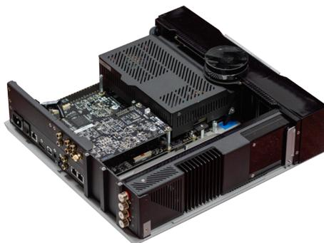
**內部：**機箱右側已經加裝了內含Katalyst DAC的擴大機模組，機箱前方的金屬網罩中是交換式電源，後方是數位處理線路。
