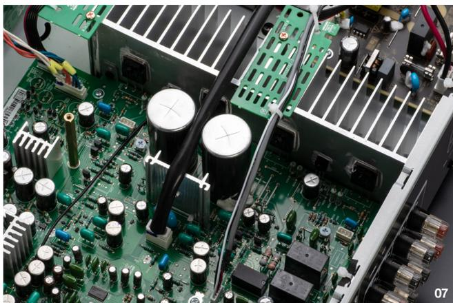
**07. 內部：**本次擴大機採用了自家Advanced HC Single Push-Pull Circuit技術，可在高頻寬下保持大電流輸出，並提升對單體的控制能力。圖中的濾波電容也是Audio等級的訂製品。
