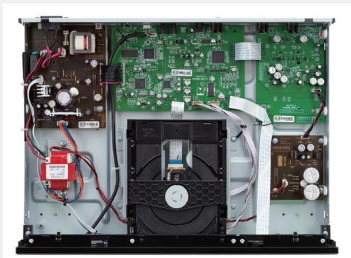
上／從機箱內部圖可以看到，Denon原廠在設計時特別將CD讀取機構設置於中央位置，同時在其周圍的電路設計也採用較為排列的排列形式。此種設計形式除了能充分利用機箱內部空間，也能達到原廠獨家的抑振效果。
