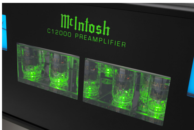
C12000面板正面可以看到的真空管是負責前級的高電平放大，這是一組前級，另外內部還有一組晶體前級線路。
