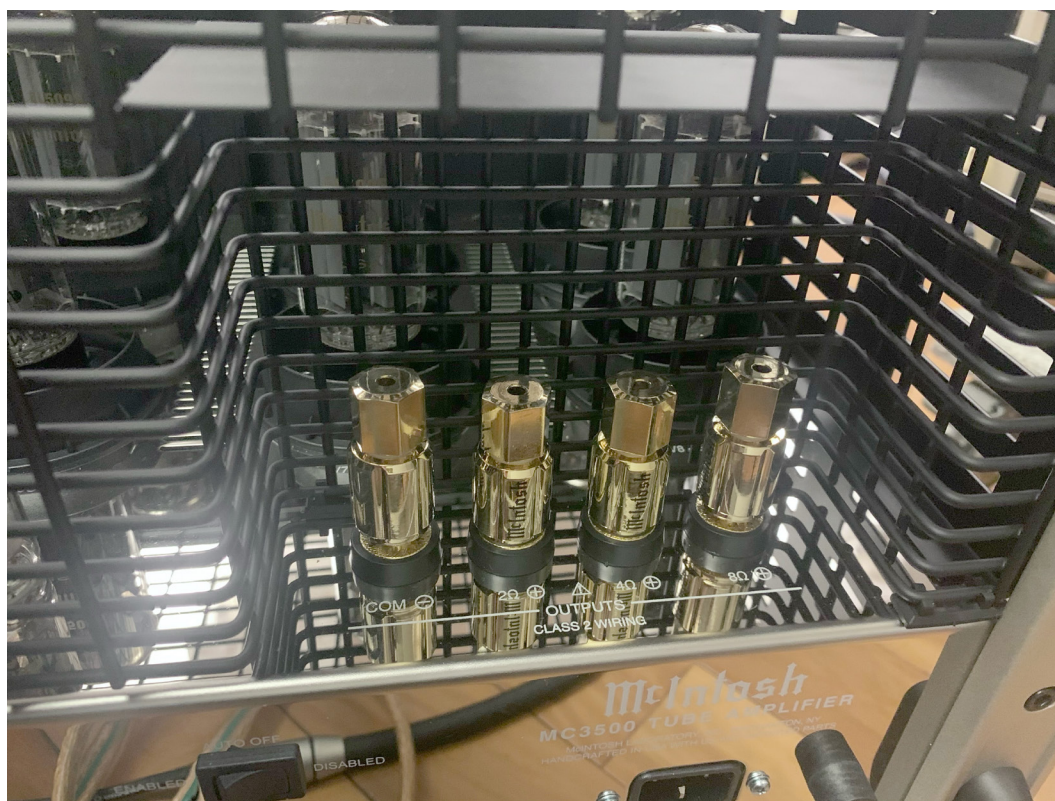
MC3500 MKII的喇叭線端子也是特製的，碩大又鍍金，很好用。四個端子中有一個是地端，其他三個是8歐姆、4歐姆、2歐姆接端。
