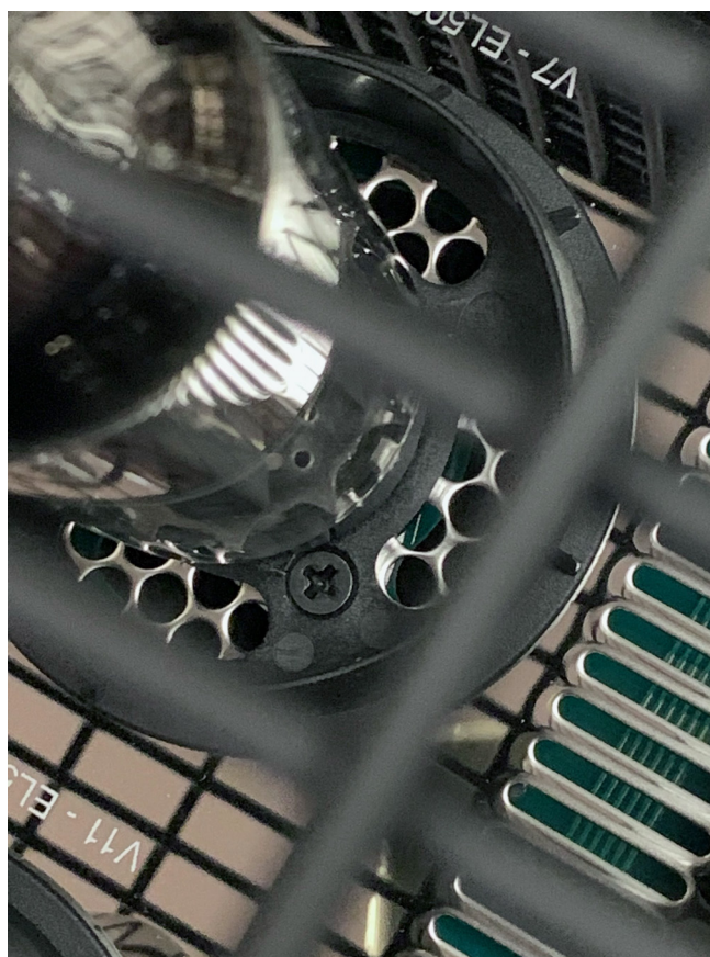
MC3500 MKII的功率管底座有通風孔，還有二個LED燈，如果管子出問題，那二個LED燈就會閃爍。
