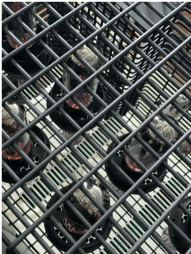
MC3500 MKII採用8支功率管與4支小管子，這些真空管以漂亮的黑色金屬柵欄保護，顯得特別關心用家安全。
