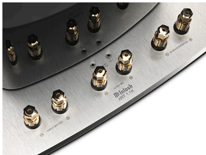
XRT 1.1K採用Tri Wire設計，可以用三組喇叭線分別對應高音、中音與低音。
