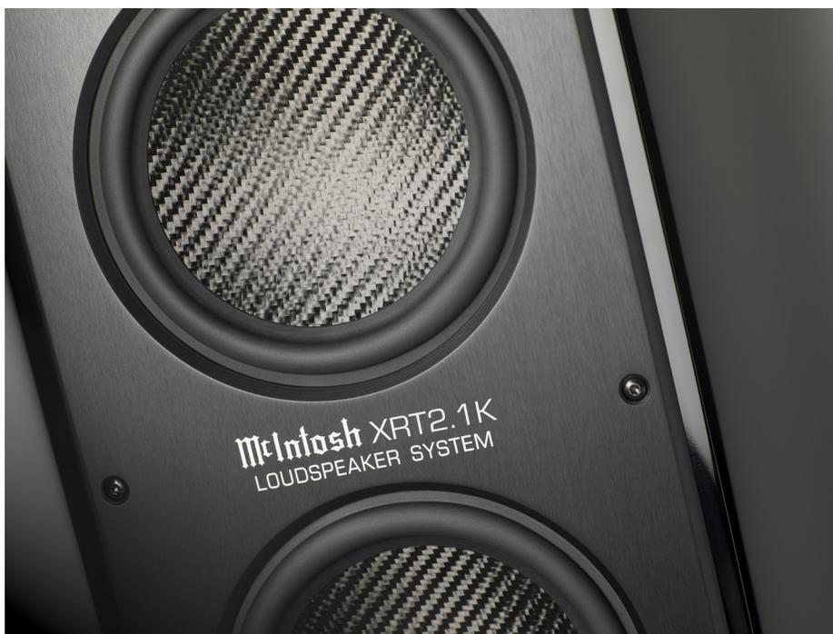
XRT2.1K的二個6.5吋中低音單體斜斜向內安裝，採用奈米碳纖維加Kevlar三明治振膜。它的主要作用是增強中頻的厚度，不會有太強的指向性。XRT2.1K的6個8吋低音單體也是採用奈米碳纖維加Kevlar三明治振膜，分為上下音箱各三個，既可降低箱體共振，又有利於搬運。
