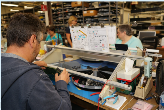
過了傳統焊錫爐之後，還要手工插入一些不耐熱的元件，此時就要以手工來焊。或許您會覺得奇怪，為何要養那麼多人，外包不就好了嗎？一來自己工廠做可以控制品質與進度，再者也雇用當地勞力，降低當地失業率，這也是企業責任。
