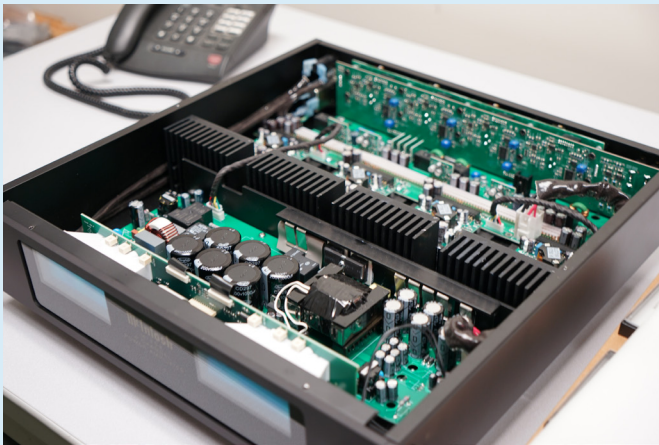
這是新研發的McIntosh四聲道後級，D類放大，AV環繞音效使用。機箱高度只有6吋，是比較特別的。
