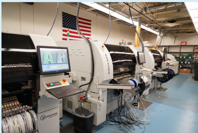
這整條生產線從頭到尾就是SMD的塗膏、上零件、烘乾機器，最末端出來的就是已經完成的SMD線路板。不過這僅是完成一部份，因為有些零件是傳統穿孔元件，還要經過第二關。穿孔元件焊好之後還有第三關怕熱的元件，那要用手焊，不能過焊錫爐。
