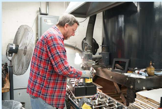
灌柏油用金屬罩子封起來的作用是讓變壓器本身不會振動，也不會產生哼聲，降低變壓器對元件所產生的負面影響。
