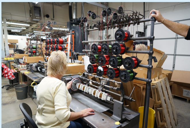
McIntosh的輸出變壓器都是自己繞製，這就是McIntosh自己開發的繞線機，可以做雙線、三線甚至多線並繞。
