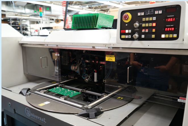
穿孔元件自動插件機的速度比較慢，一次只能放置七個元件。
