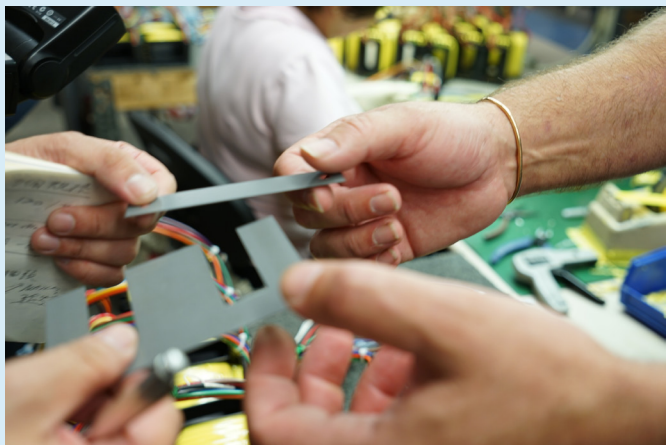
這就是EI型變壓器的鐵心，您看鐵心一邊是E型，一邊是I型，所以稱為EI型變壓器。EI型變壓器的鐵心使用的是M6鐵心。
