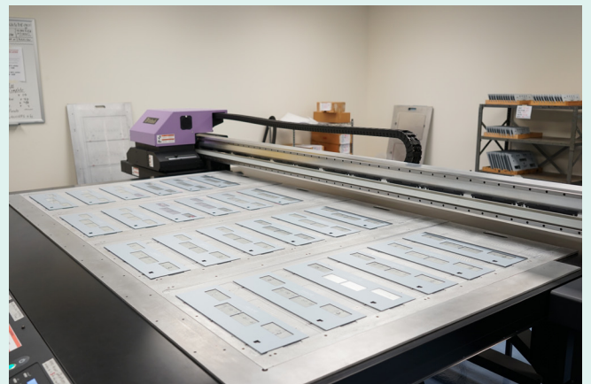
這是新的玻璃面板印刷機，一次可以印刷24片玻璃面板，一天可以製作150片面板。
