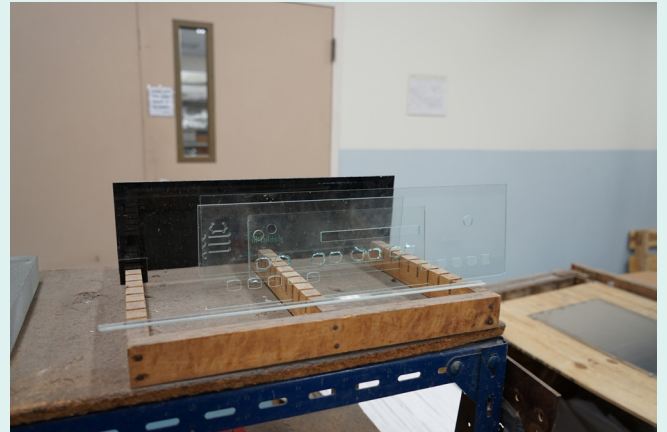
這些玻璃面板是打好孔的，準備要印刷。每種機器的玻璃面板厚薄並不一樣，前級面板薄，後級面板厚。
