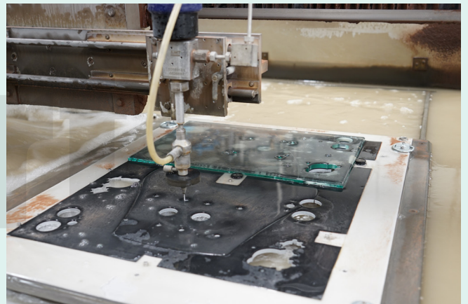
水刀的噴口直徑大約等於一根頭髮，射出的水壓高達60,000 psi。
