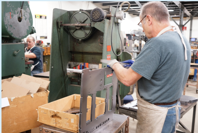
McIntosh廠內有金工部門，機箱以不鏽鋼、鐵板、鍍鉻板所組成，鍍鉻板要外包，其餘都在廠內完成。
