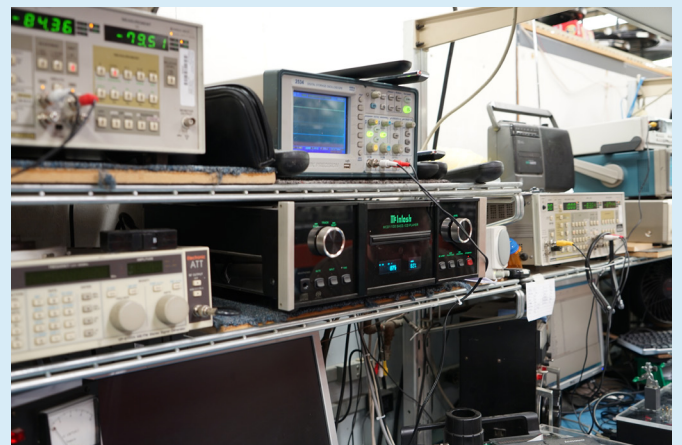
McIntosh工廠內到處可以看到這類測試儀器，因為每一塊線路板、每一部機器都要百分百測試，不是抽驗。
