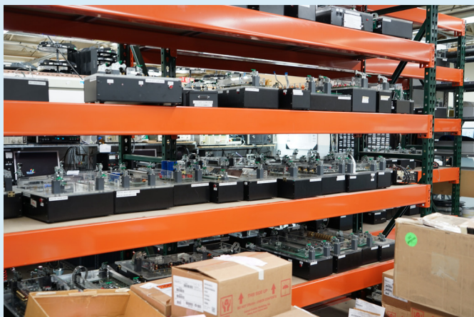
工廠內部很大，這是第一眼看到的架子，上面都是線路板測試模組，這些模組是用來測試功能的，而非失真數據。
