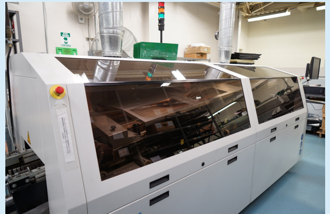
插好元件的線路板準備送到下一站傳統Wave焊錫爐。為何稱為Wave呢？因為焊錫爐裡的液態焊錫要調整湧浪的高低，讓液態焊錫剛好跟穿孔元件的腳接觸到，不能太高（吃錫太多），也不能太低（吃錫不夠）。所以雖然傳統Wave焊錫爐不是高科技，但要仔細調整，才能讓線路板的元件確實焊牢。
