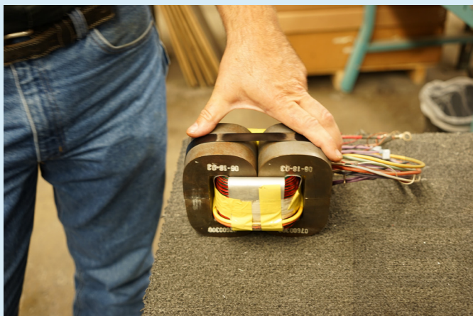
這是雙C Core鐵心，專門用來給大功率擴大機輸出變壓器使用。一個重約18公斤。
