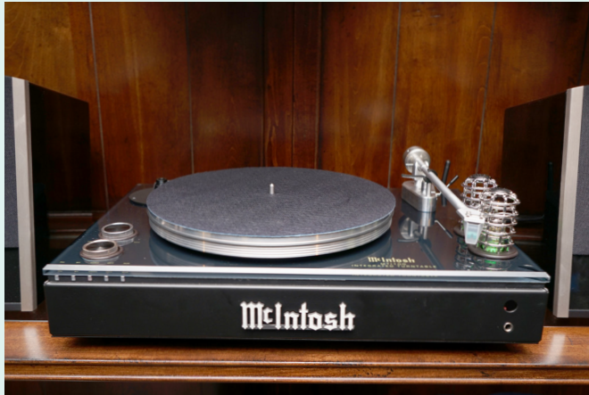
這是MTI 100 All in One黑膠唱盤，右邊有二支真空管，應該是前管後晶混血設計，內建D類100瓦綜合擴大機，還有藍牙、光纖、同軸、Aux輸入端，還有耳機插孔。
