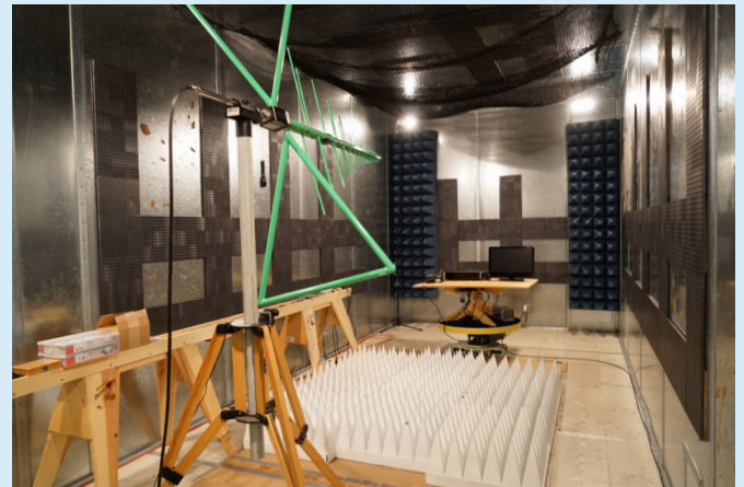
這是EMI測試室，McIntosh的產品行銷世界各地，各種規格都必須達標，很少看到音響製造廠有自己的EMI測試室。
